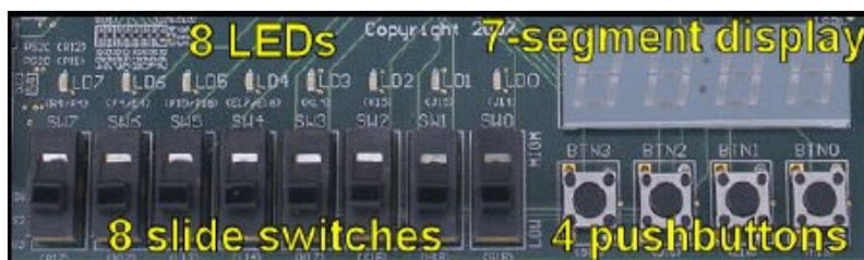
Слика 5. а) Улазно/излазни (I/O) уређаји Digilent Nexys 2 платформе б) Осцилатор (Clock) од 50MHz и подножје за секундарни осцилатор
