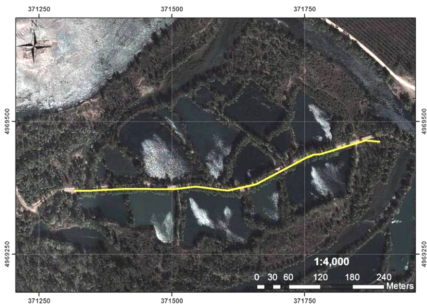
Slika 17. Lokacija napuštene eksploatacije pozicionirana na SASPlanet-Google satelitskom snimku - jasno se vidi devastacija zemljišta zapunjena vodom (žuta linija označava deo puta kroz devastirano zemljište nastalo nekontrolisanom eksploatacijom šljunka) (Grupa autora, 2014)
