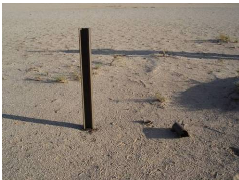
Slika 20. Orijentir (trigulacioni) za postavljanje istražnih bušotina po traversama u pustinji Gobi, oblast Narsta (istočna Mongolija), fotografija B. Vakanjac 2006
