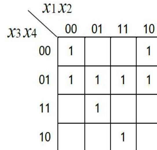
$$f = \overline{x_3}x_4 + \overline{x_2}\overline{x_3} + \overline{x_1}x_2x_4 + x_1x_2x_3\overline{x_4}$$
