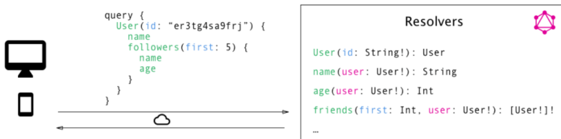
Slika 7. Svako polje u upitu odgovara jednoj resolver funkciji. GraphQL.
