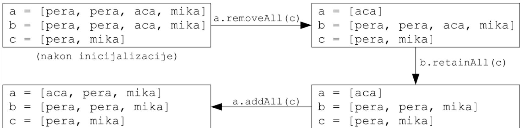
Slika 10.2: Efekat primene metoda `removeAll`, `retainAll` i `addAll`
