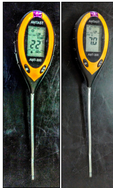
Геотермометри са електронским дисплејем: лево - са додатком за бушење тла, десно са рН показатељем.
