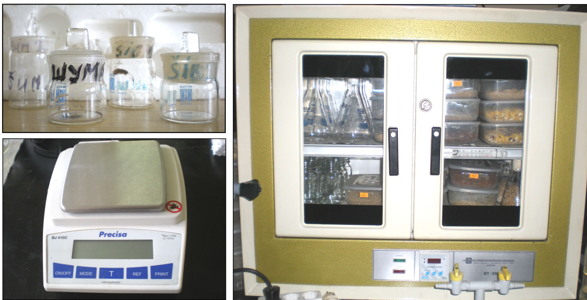
Лабораторијска опрема за одређивање влажности земљишта: вегеласи, прецизна вага и сушница.
