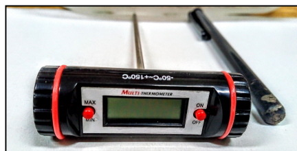
Геотермометри са електронским дисплејем: лево - са додатком за бушење тла, десно са рН показатељем.
